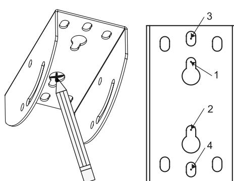
**CZ:** Po výběru vhodného nosného bodu na připevnění konzoly položte komponenta **(M1)** na strop a pomocí pera vyberte nejméně 4 upevňovací body. Doporučujeme použít díry na středu konzoly.
