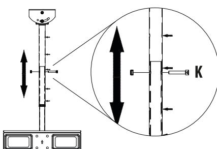
CZ: Upevněte délku opěrné tyče podle potřeby pomocí šroubů, které naleznete v balení.
