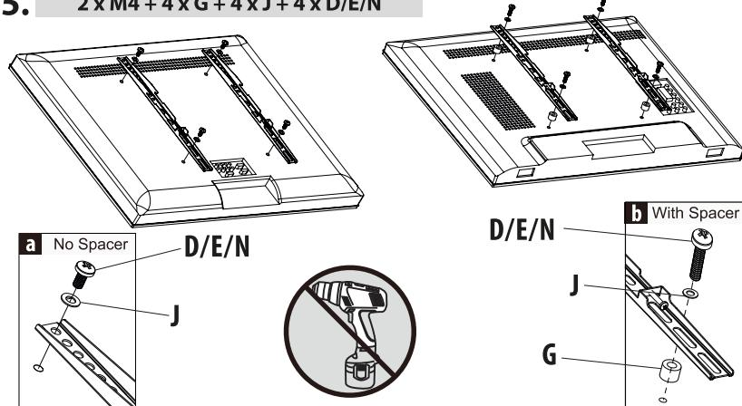
**CZ:** Na zadní stranu TV nebo monitoru namontujte opěrnou kolej (M4) s VESA standardem. V případě potřeby použijte rozpornou šroub (G) mezi zadní stěnou TV a kolejí. Během připevnění kolej použijte vhodné šrouby (D/E/N) a podložky (J) k televizoru.
