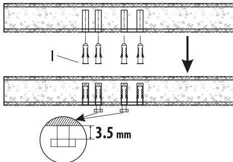
**CZ:** Do dvou středních hmoždinek se pokuste vložit šrouby M8 x 60 s označením (**H**). Mezi rovinou stěny a hlavou skrutky může být maximální vzdálenost 3,5 mm abyste dosahli vhodné upevnění.
