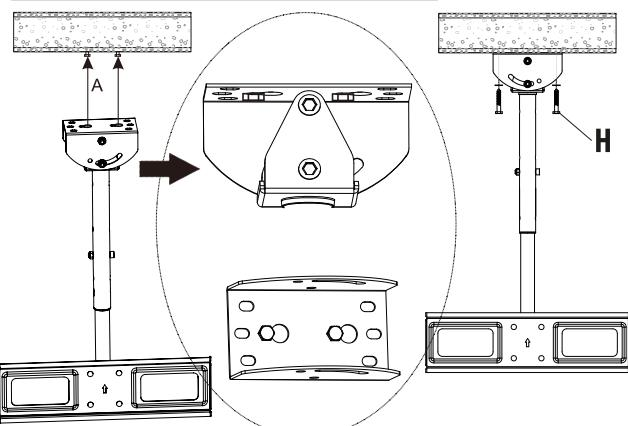
CZ: V zájem správneho pripievného utáhněte všechny šrouby. Po kontrole všech šroubů, pripočte konzolu (M1) k 6 vyvrťaným díram a upevněte ji pomocí šroubů s označením (H). V případě potřeby použijte podložky.
