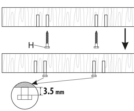
**CZ:** Do dvou středních dér zkuste vložit šrouby M80 x 60 s **(H)** označením. Mezi rovinou stěny a hlavou skrutky může být maximální vzdálenost 3,5 mm abyste dosáhli vhodné upevnění.
