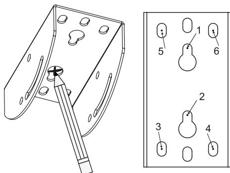
**CZ:** Po výběru vhodného nosného bodu na připevnění konzoly položte komponenta (**M1**) na strop a pomocí pera vyberte nejméně 6 upevňovacích bodů. Doporučujeme zvolit 3-3 body na každé straně.
