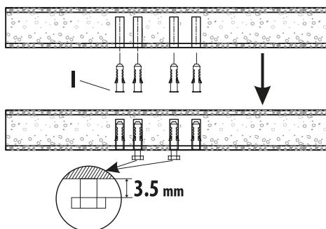
**EN:** Stecken Sie die mit **(H)** gekennzeichneten 8 x 60-Schrauben in die Dübel in den beiden mittleren Löchern. Der maximale Abstand zwischen der Deckenebene und dem Schraubenkopf darf bei 3,5 mm liegen, damit Sie den Konsolenkopf richtig befestigen können.
