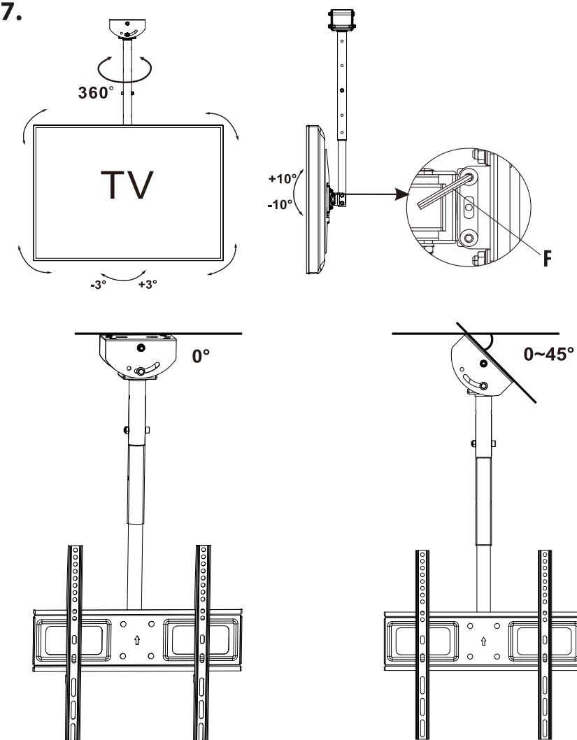
**CZ:** Úhel televizoru můžete upravit uvolněním a připevněním dvou imbusových šroubů na zadní straně. Po správném namontování lze zařízení otočit o 360°. Výrobce a distributor neodpovídají za žádné škody způsobené nesprávnou a správnou montáží.
