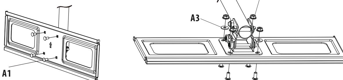
CZ: Namontujte kolej (M3) na opěrnou tyč (M2) pomocí 4 šroubů (A1), podložek (A2) a matic (A3). Dbejte na to aby šípka na přední straně směrovala nahoru ve směru opěrné tyče.
