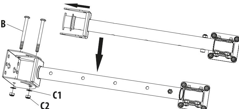
CZ: Hlavu konzoly (M1) a tyč (M2) smontujte spolu se dvěma M8 x 95 hřidelemi (B). K připevnění hřidele používejte podložku (C1) a matici (C2) kterou naleznete v sáčku.Jeden hřidel umístěte tak aby byl volna nastavitelný do 45 stupňového úhlu a k druhému použijte díru umístěnou na středu.
